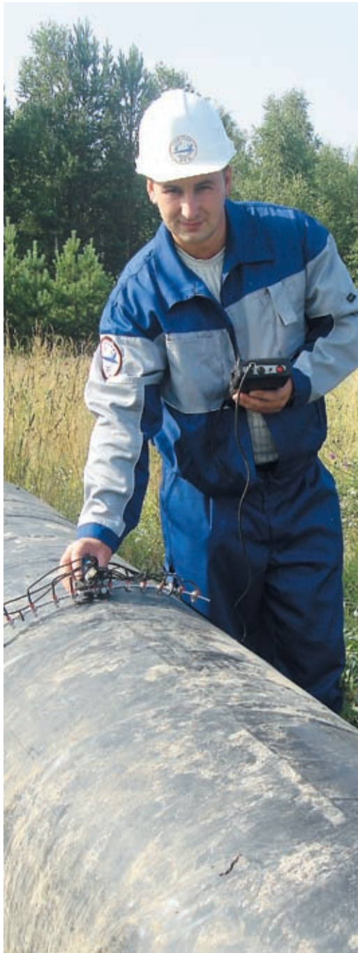
Андрей Монастырный, проводит диагностику трубы методом магнитной памяти металла
